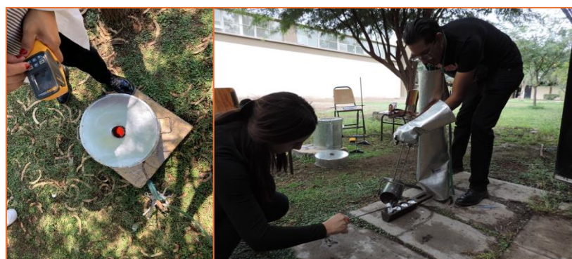
Figura 4. Pruebas de Funcionamiento, fundición y vaciado de Al.
