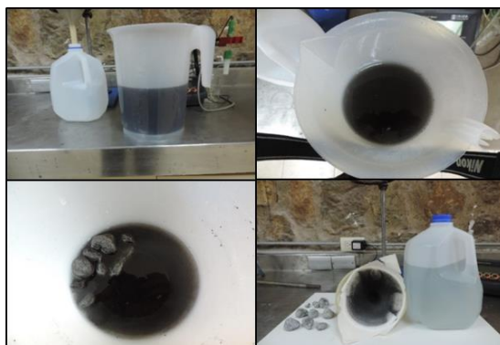
Figura 9. Obtención de \text{Al}_2(\text{SO}_4)_3 por reacción de botones de la fundición de chatarra de Al con solución de \text{H}_2\text{SO}_4
