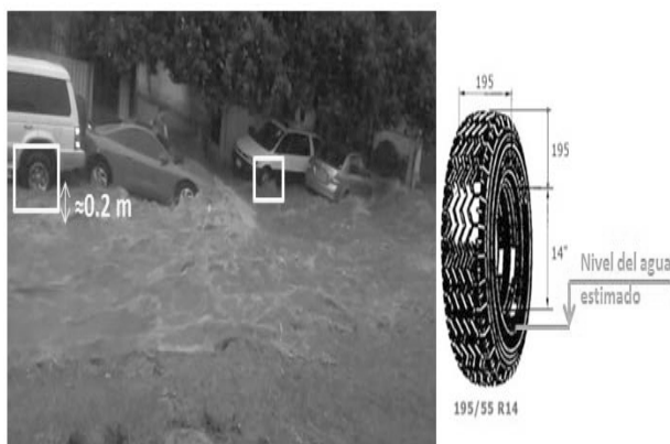
Figura 6.- Estimación del nivel de agua en la zona de análisis.
