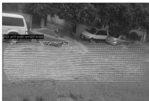
Figura 3.- Campo de velocidad media superficial obtenido al aplicar la técnica LSPIV
